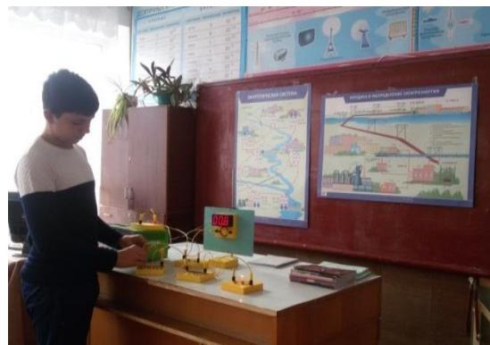
**Учащиеся** формулируют выводы: при последовательном соединении напряжение на каждом потребителе различно. Измеряет общее напряжение в цепи.
